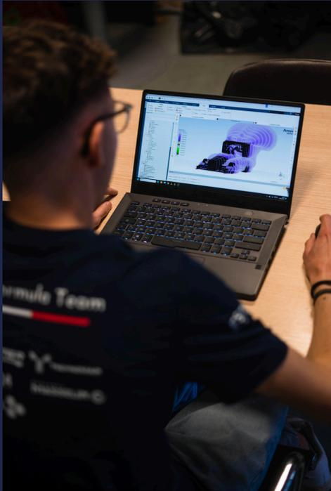
Le pôle aérodynamique a repris ce mois-ci les simulations numériques (CFD) sur la voiture complète, tout en formant les nouvelles générations de l'association à ces simulations ainsi qu'à l'utilisation d'Ansys Fluent. De son côté, la sous-section fabrication a produit de nombreuses éprouvettes en vue de réaliser des essais de traction le 7 novembre prochain, dans le but d'améliorer nos procédés de fabrication composite (laminage, collage, etc.).
