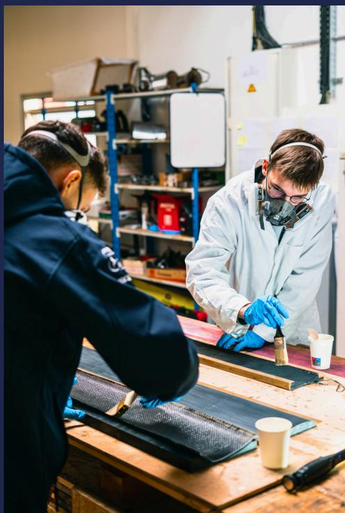
Le pôle aérodynamique a débuté ce mois-ci la fabrication des nouvelles ailes qui composeront les prochains ailerons de EC-05. Pour cela, nous avons réalisé des moules en impression 3D qui nous permettent de laminier nos pièces à la forme souhaitée.
