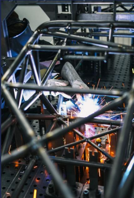
Le mois de mars était dédié à la finalisation du châssis tubulaire chez notre partenaire Faster Racing. Les derniers points de fixation sont en train d'être soudés et nous pourrons, ensuite, envoyer le châssis en peinture.
